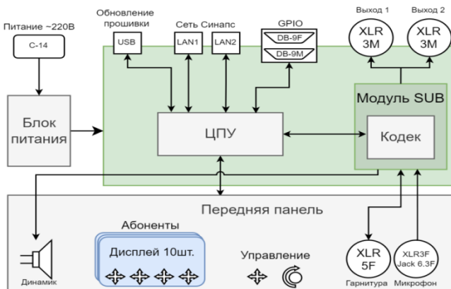
Рисунок 2.1 - Блок ТР-840. Структурная схема
