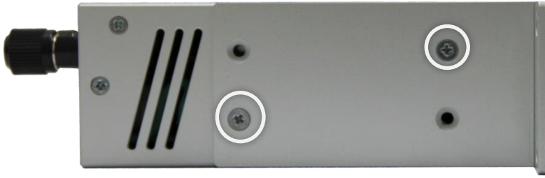
Рисунок 6.2 - Крепление уголка к блоку TP-702-1M
