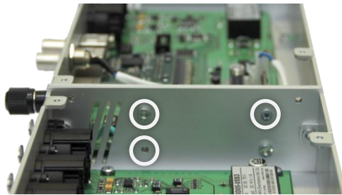
Рисунок 6.4 - Соединение двух блоков TP-702-1M.
