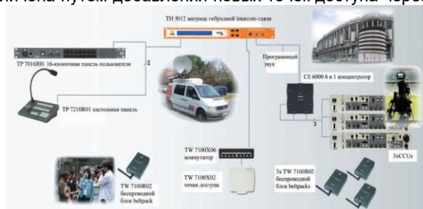
Организация служебной связи на базе оборудования Kroma Telecom
