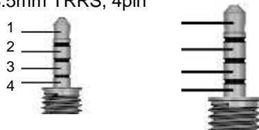
Рисунок 2.5 - Цоколёвка разъёма Jack 3.5mm TRRS, 4pin
