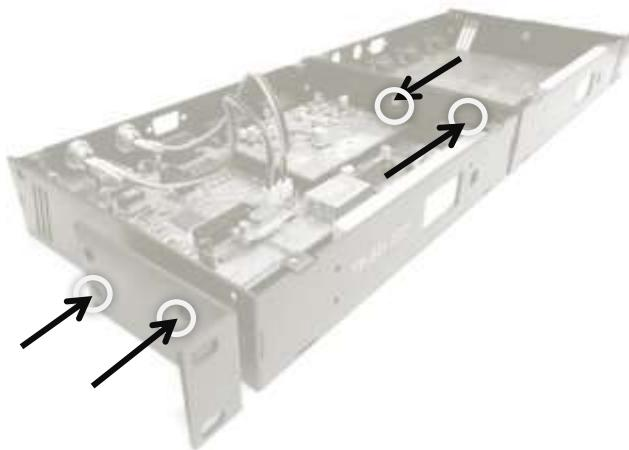
Рисунок 3.5 - Установка двух Блоков в стойку RACK 19"
