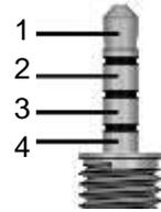
Рисунок 2.8 - Цоколёвка разъёма Jack 3.5mm TRRS, 4pin
