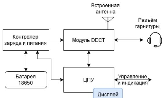
Рисунок 2.5 - ТР-806. Схема структурная
