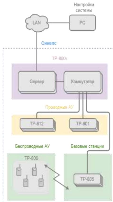
Рисунок 2.1- Беспроводной комплект связи в составе Синапс
