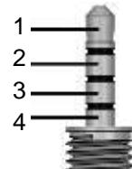
Рисунок 2.8 - Цоколёвка разъёма Jack 3.5mm TRRS, 4pin
