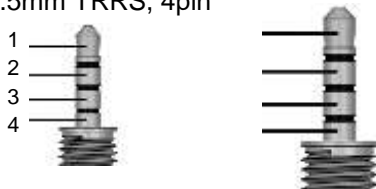
Рисунок 2.5 - Цоколёвка разъёма Jack 3.5mm TRRS, 4pin
