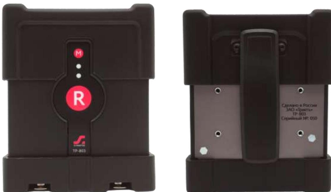
Рисунок 2.2 - Передняя и задняя панели TP-803
