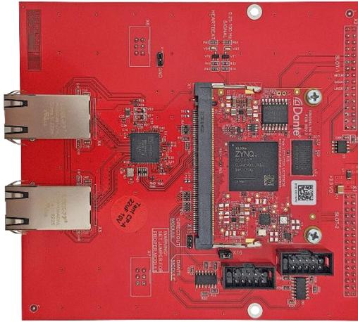
Рисунок 3.4 – Внешний вид модуля TP-804- Dante
