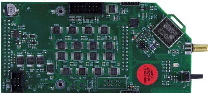
Рисунок 3.5 – Внешний вид модуля TP-804- DECT
