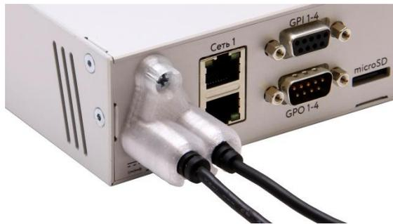
Рисунок 5.1 – Фиксатор кабеля БП
