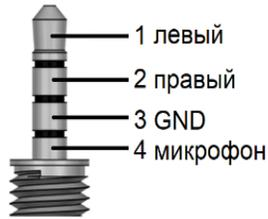
Рисунок 4.4 - Цоколёвка разъёма Mini-Jack 3.5mm 4pin
