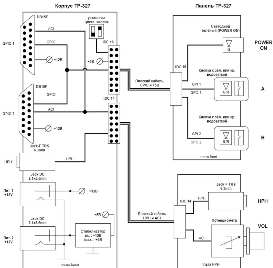
Рисунок 2.5 - TP-327. Схема структурная
