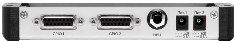
Рисунок 2.3 – Корпус TP-328, вид спереди.
