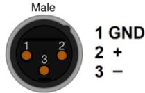
Рисунок 3 – Разъём XLR-M
