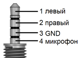
Рисунок 2.5 - Цоколёвка разъёма Jack 3.5mm TRRS, 4pin
