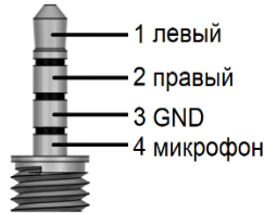
Рисунок 4.4 – Цоколёвка разъёма Mini-Jack 3.5mm 4pin
