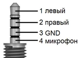
Рисунок 2.5 – Цоколёвка разъёма Jack 3.5mm TRRS, 4pin
