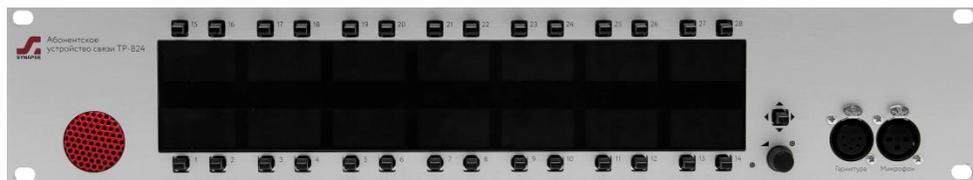
Рисунок 2.2 – Блок TP-824. Передняя панель
