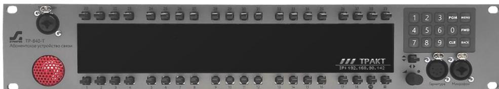
Рисунок 2.2 - Блок TP-840T. Передняя панель
