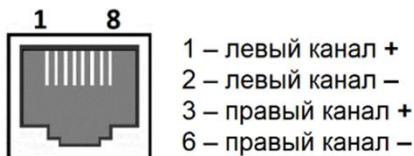
Рисунок 3.1 - Разъём RJ-45
