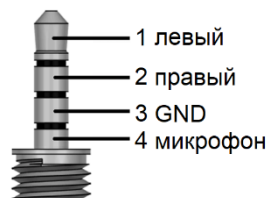
Рисунок 2.5 – Цоколёвка разъёма Jack 3.5mm TRRS, 4pin
