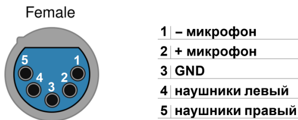
Рисунок 3.3 - Цоколёвка разъёма XLR5 F
