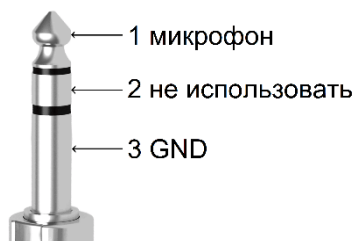
Рисунок 3.1 - Цоколёвка разъёма Jack 3.5mm TRS, 3pin
