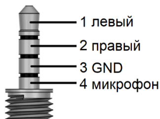
Рисунок 3.2 - Цоколёвка разъёма Jack 3.5mm TRRS, 4pin
