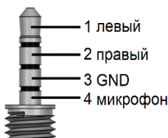
Рисунок 4.4 – Цоколёвка разъёма Mini-Jack 3.5mm 4pin
