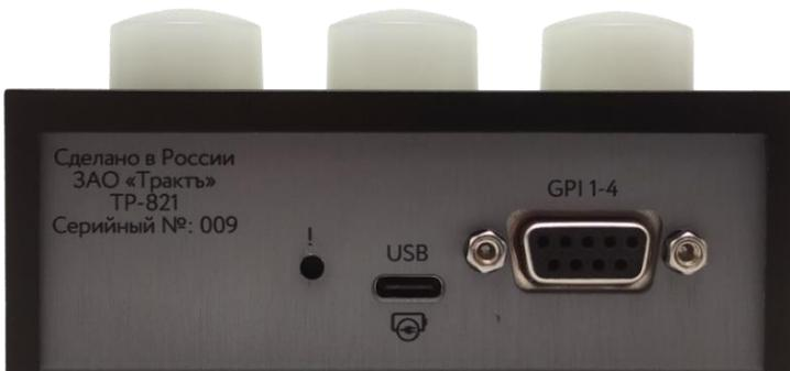
Рисунок 3.3 - Блок TP-821. Задняя панель
