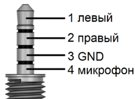
Рисунок 2.5 – Цоколёвка разъёма Jack 3.5mm TRRS, 4pin
