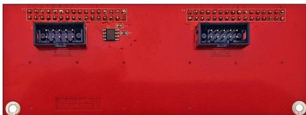
Рисунок 2.4 – Внешний вид модуля расширения TP-804-AES67-EXT
