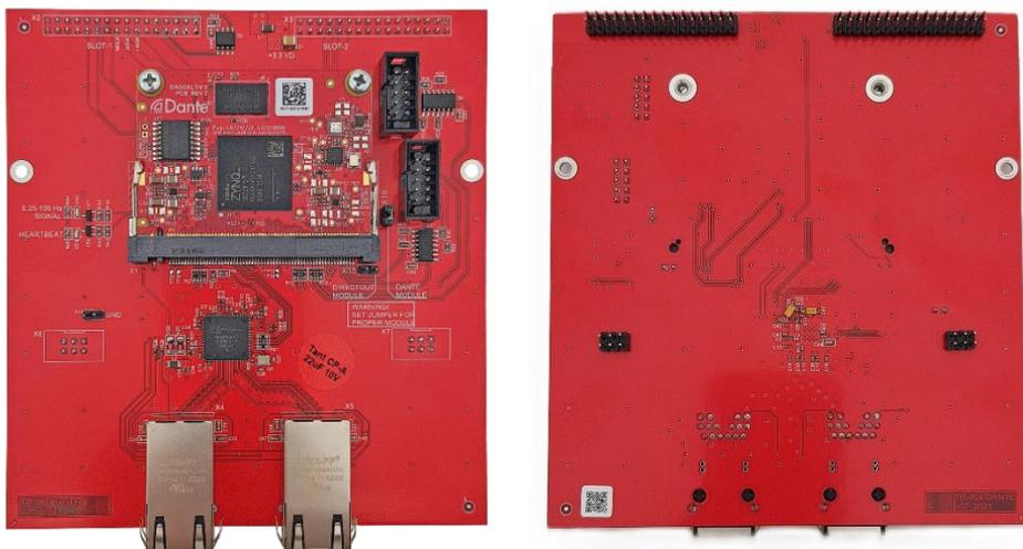
Рисунок 2.3 – Внешний вид модуля TP-804-AES67
