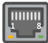
Рисунок 2.3 – Цоколевка разъема RJ-45
