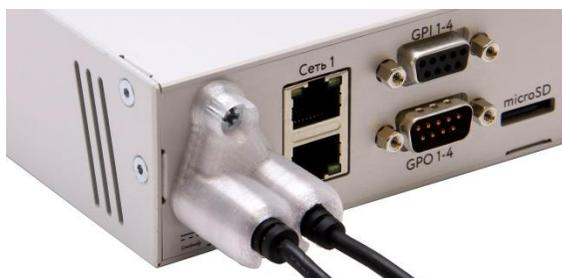
Рисунок 3.1 – Фиксатор кабеля БП
