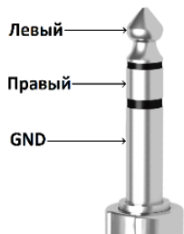
Рисунок 4 – Цоколёвка разъёма Jack 6.3mm 3pin
