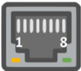
Рисунок 7 - Контакты разъёма GPO (RJ-45)
