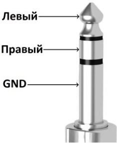
Рисунок 2.3 – Цоколёвка разъёма НРН , Jack 6.3 М
