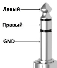
Рисунок 2.6 – Цоколёвка разъема HPH, Jack 6.3 M
