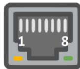
Рисунок 2.3 – Цоколевка разъема RJ-45
