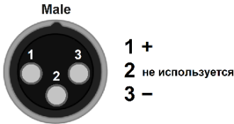
Рисунок 2.6 – Цоколевка разъема mini XLR3
