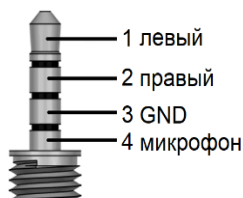
Рисунок 4.4 – Цоколёвка разъёма Mini-Jack 3.5mm 4pin
