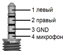
Рисунок 4.4 – Цоколёвка разъёма Mini-Jack 3.5mm 4pin
