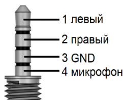
Рисунок 4.4 – Цоколёвка разъёма Mini-Jack 3.5mm 4pin
