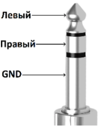
Рисунок 4 – Цоколёвка разъёма Jack 6.3mm 3pin
