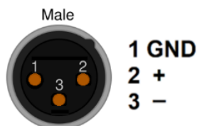
Рисунок 3 – Цоколёвка разъёма XLR-M
