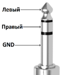
Рисунок 4 – Цоколёвка разъёма Jack 6.3mm 3pin
