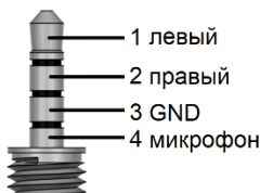
Рисунок 4.4 – Цоколёвка разъёма Mini-Jack 3.5mm 4pin
