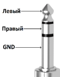
Рисунок 4 – Цоколёвка разъёма Jack 6.3 mm 3-pin
