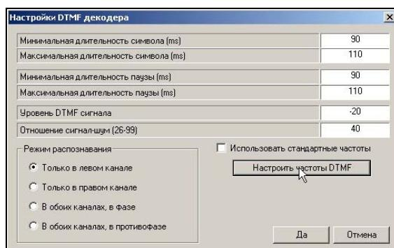
Рис. 47. Настройка DTMF-кодера
