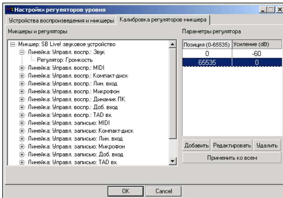
**Рис. 49. Диалоговое окно Настройки регуляторов уровня, закладка Калибровка регуляторов микшера**
