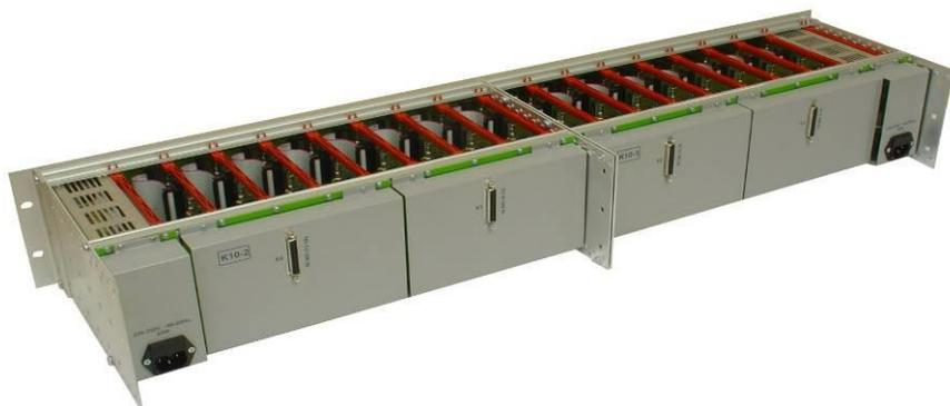
Размещение модулей питания с двух сторон улучшает тепловой режим блока.
