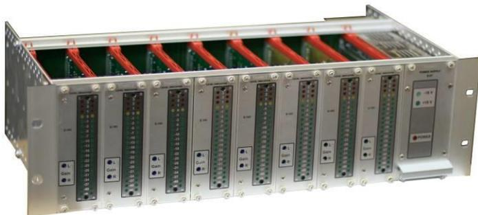
Рис.14. Вид на блок TP-E-103 с лицевой стороны с 8-ю модулями индикаторов уровня и модулем блока питания E-07.
