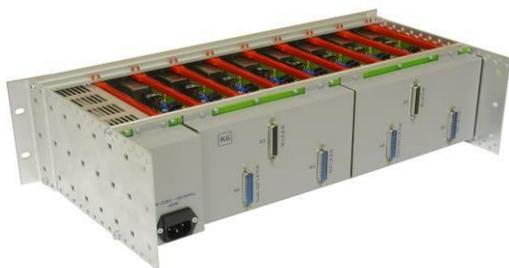
Вид на корзину BOPLA с тыла. Видны два кожуха с отверстиями под разъемы типа D-sub. Под кожухами установлены кросс-платы. Левый кожух имеет сетевой ввод для блока питания.
