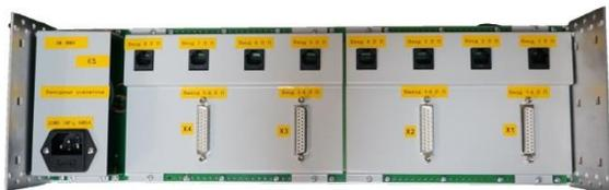
Рис. 12. Вид на блок выходных усилителей сзади.
