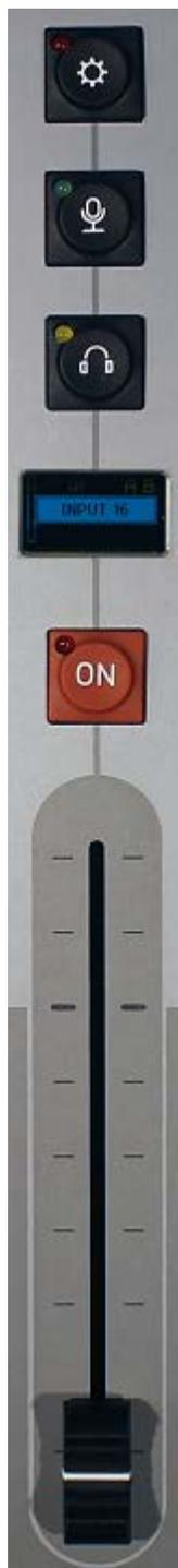
Микшерский пульт TR-4 имеет 16 каналов с входными регуляторами уровня (фейдерами), 4 кнопки в каждом канале со светодиодными индикаторами и OLED дисплей. Внешний вид канала пульта представлен на рисунке слева.
