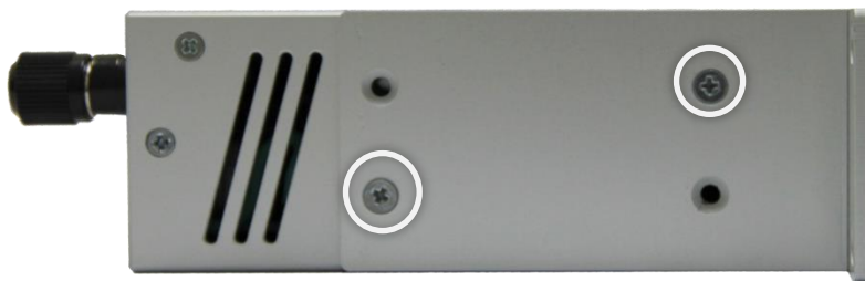
Рисунок 6.2 - Крепление уголка к блоку TP-702-1M
