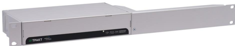
Рисунок 6.1 - Установка одного блока TP-702-1M в стойку RACK 19"
